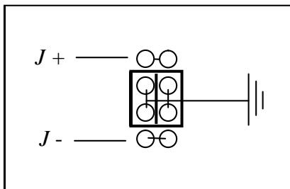
Рис. 9 Снятие заземления с выходных клемм источника
