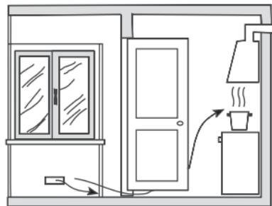
Забезпечення необхідного зазору між дверима приміщення та порогом для вільного проходу приливного повітря
