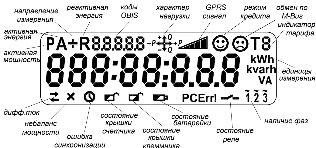
Рис. 6.1. Вид общего дисплея счетчика (символы + коды OBIS) в тестовом режиме. Все сегменты активны
