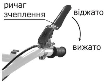
Культиватор оснащений функцією реверсу для кращого маневрування. Для того, щоб фрези почали зворотне обертання, переключіть ричаг КПП в положення «-1» та натисніть та утримуйте ричаг зчеплення.
