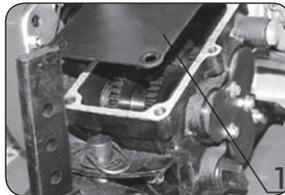
Для запобігання попаданню усередину пристрою сторонніх речовин та предметів під час транспортування передбачена додаткова металева кришка для транспортування (1). Перед установкою рулевої колонки (2) кришку необхідно зняти.
