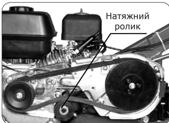
3. Зніміть чотири болти кріплення двигуна для проведення робіт з регулювання. Рухайте двигун вперед або назад для досягнення необхідного натягу ременя та переконайтеся, що зовнішні поверхні ведучого та веденого шківів знаходяться в одній площині.
