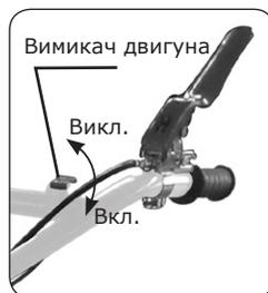
Для виключення двигуна переведіть перемикач в положення 0 (викл.).
