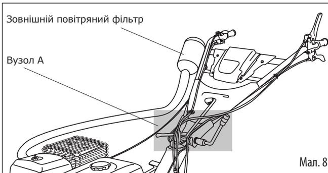
Регулювання висоти панелі оператора та кута напрямку руху здійснюється за допомогою вузла А.
