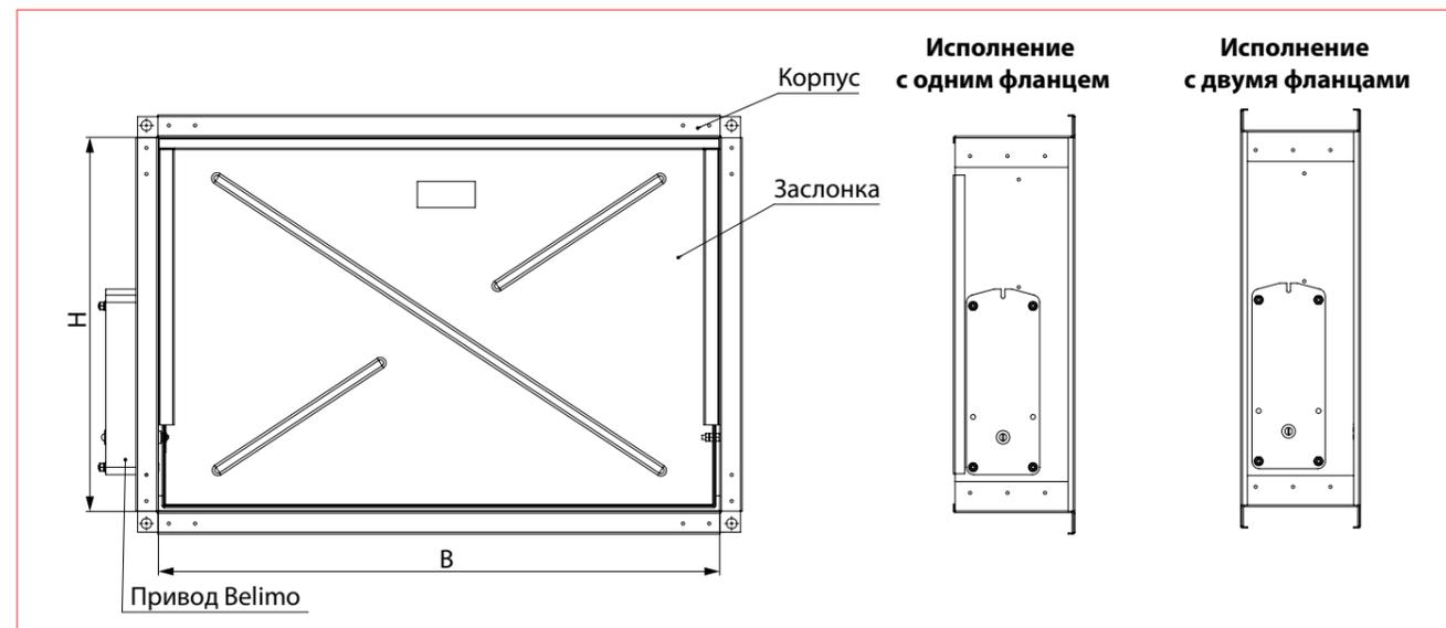
Площадь проходного сечения клапана дымоудаления КПД с электроприводом **Belimo** установленным **снаружи** клапана, м<sup>2</sup>
