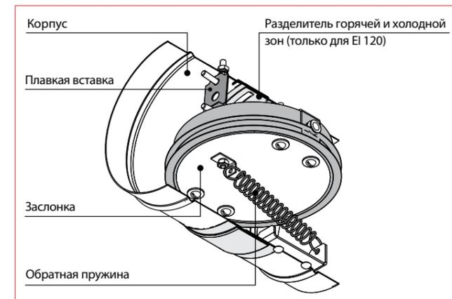
**■ Клапан противопожарный ПЛ-10-2-BLF230-T и ПЛ-10-2-BLF24-T с электроприводом Velimo и термозлектрическим размыкающим устройством**
