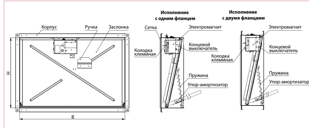
Площадь проходного сечения клапана дымоудаления КПД с электромагнитом, м<sup>2</sup>
