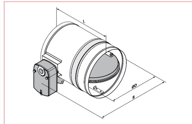
■ Габаритные и присоединительные размеры клапанов ПЛ:
