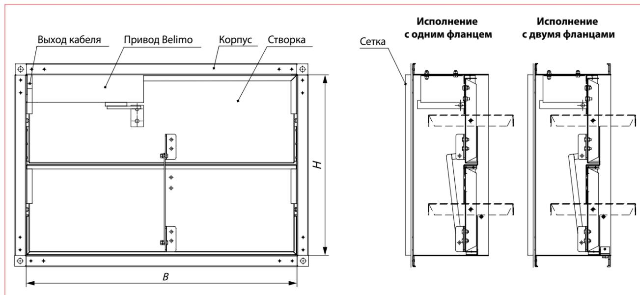
Площадь проходного сечения клапана дымоудаления КПДУ с электроприводом **Belimo** установленным **внутри** клапана, м<sup>2</sup>
