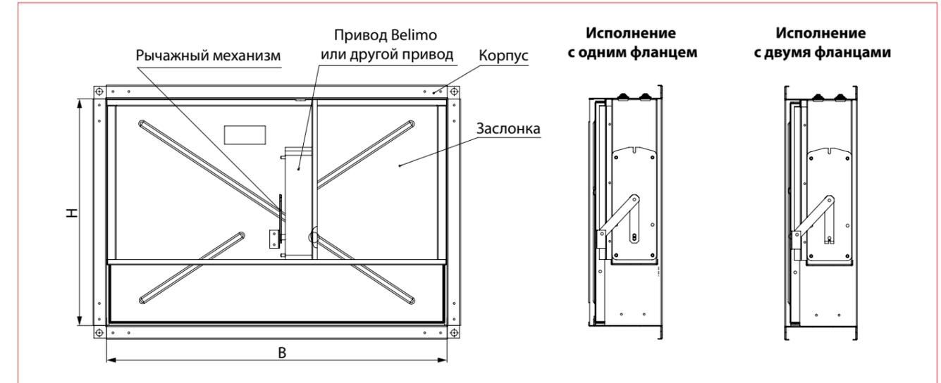
Площадь проходного сечения клапана дымоудаления КПД с электроприводом Belimo установленным внутри клапана, м<sup>2</sup>
