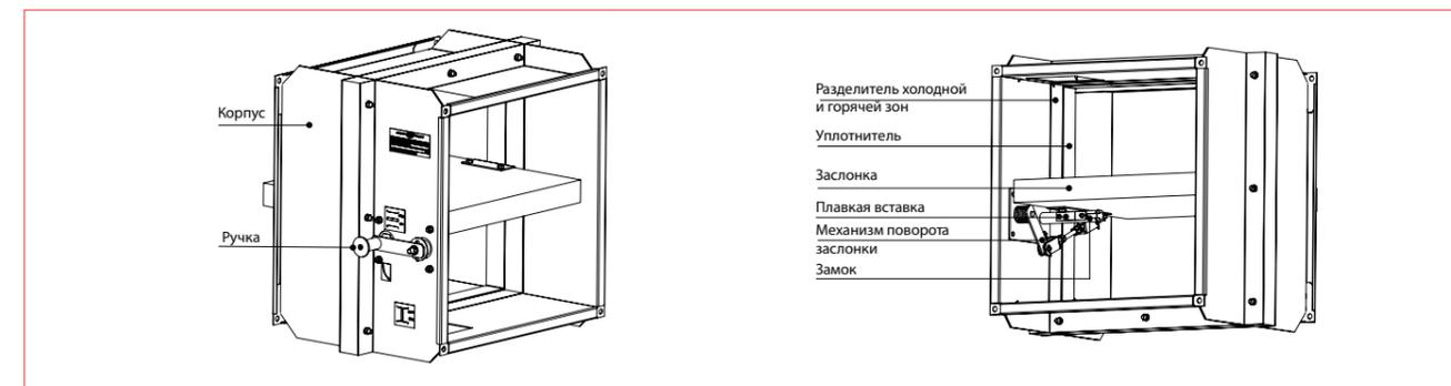
**■ Клапан противопожарный КП-2...BLF и КП-2...BF с электроприводом Belimo и термоэлектрическим размыкающим устройством**
