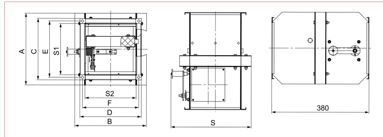
Площадь проходного сечения канального огнезадерживающего клапана с механическим приводным устройством, м<sup>2</sup>
