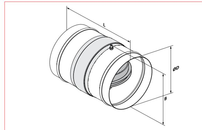
■ Клапан противопожарный с электроприводом Belimo и термоэлектрическим размыкающим устройством
