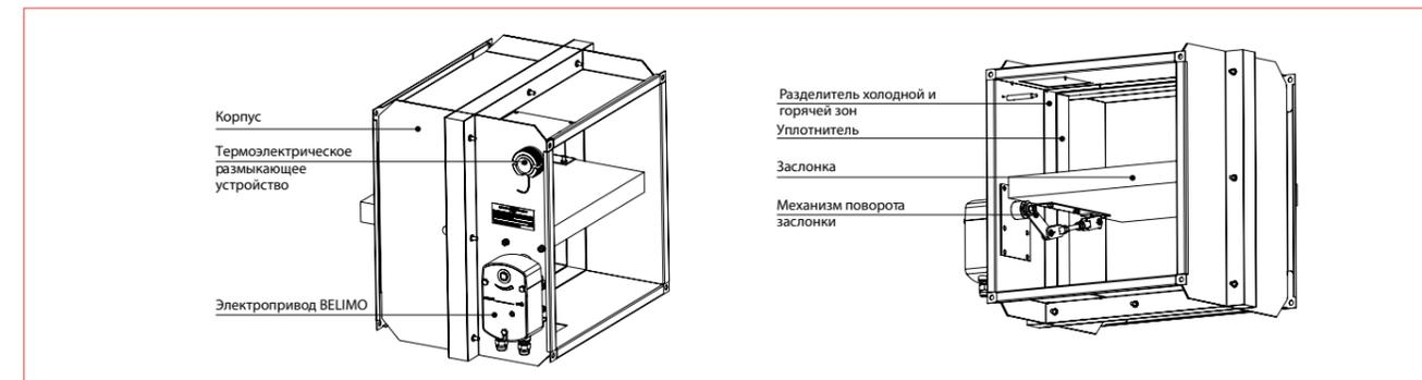
**■ Клапан противопожарный КП-2...BLF...-1 и КП-2...BF...-1 с электроприводом Belimo и термоэлектрическим размыкающим устройством**
