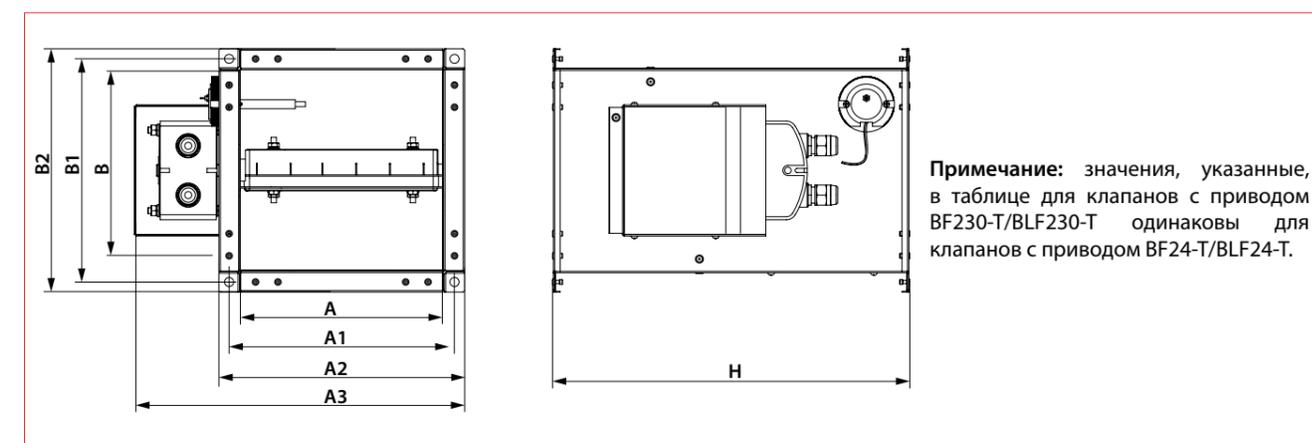
Площадь проходного сечения канального огнезадерживающего клапана с электроприводом Belimo установленным снаружи клапана, м<sup>2</sup>
