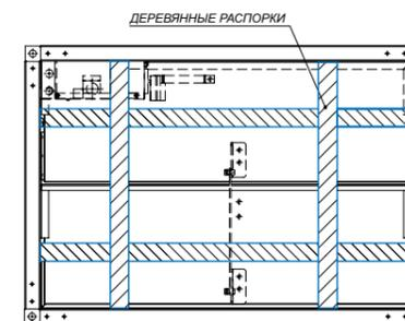
После обмуровки клапана в дымовой шахте, противопожарной стене или перекрытии и полного затвердения (фиксации) уплотнения, деревянные распорки снять, при этом створка должна открываться свободно, без трения. Заземлить клапан, подключить электромагнит или электропривод (в зависимости от модификации) к автоматической системе пожаротушения, провести тестирование срабатывания клапана.
