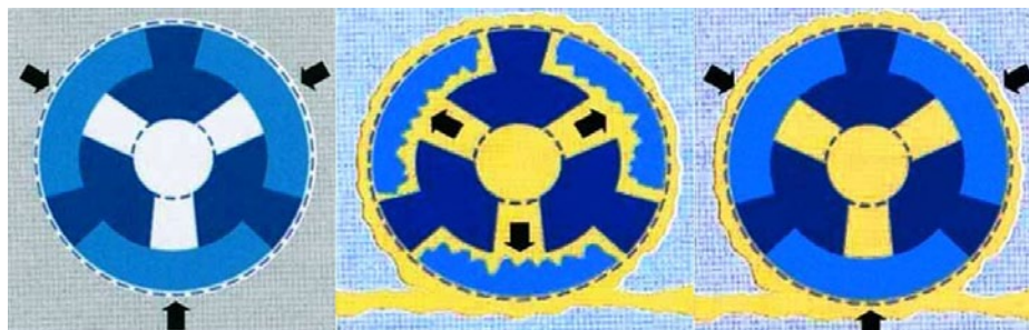
Обжатие бетонной смесью — клапаны закрыты
