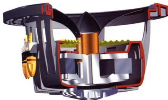
*Pour éliminer les effets tourbillonnaires au centre du cône, le médium T16PG110 occa troqué son cache-noyau contre une ogive. Pour affronter les dynamiques les plus sévères il est équipé du système LHS2 d'évacuation des calories dégagées par la bobine mobile.*
