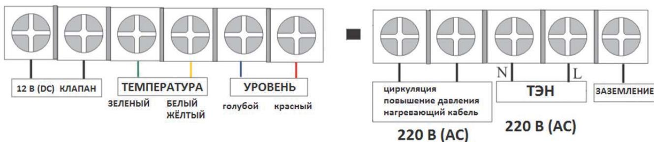
Контроллер M-8NEW содержит датчик температуры и уровня воды с четырехжильным проводом и электромагнитным клапаном давления DC 12 В.
