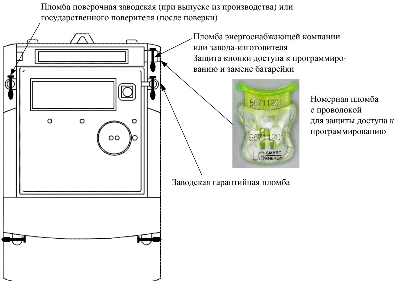
Рисунок 2 – Места установки пломб
