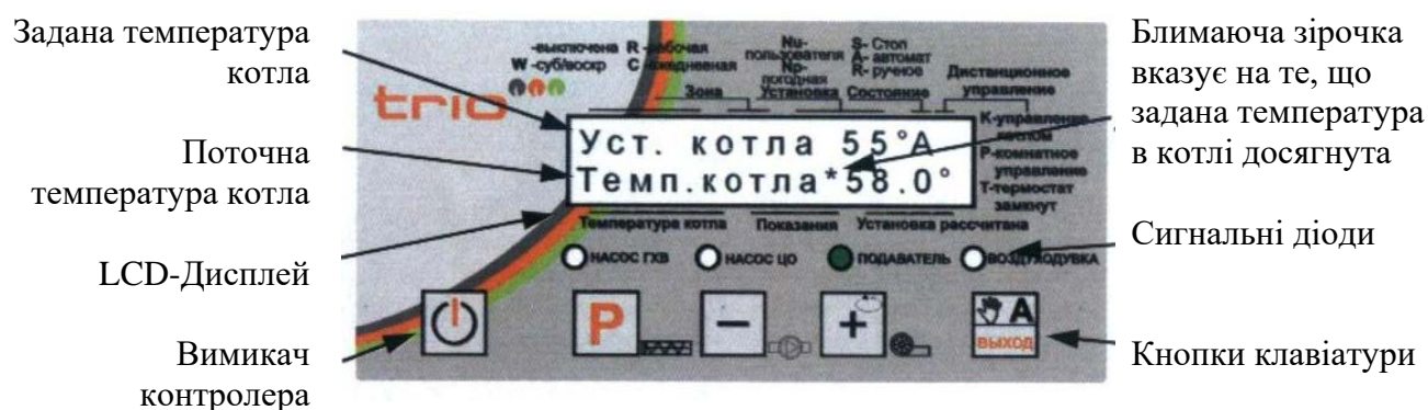
Рисунок 2 – Зовнішній вигляд передньої панелі контролера
