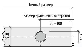
Отверстие Ø 10,8 мм
