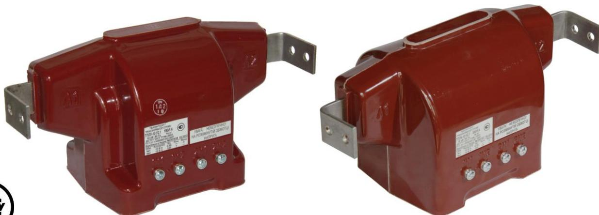
Трансформаторы тока ТПЛУ-10-1 предназначены для передачи сигнала измерительной информации измерительным приборам, устройствам защиты и управления, для изолирования цепей вторичных соединений от высокого напряжения в комплектных электрических устройствах внутренней установки (КРУ, КРУН, КСО) переменного тока на класс напряжения 10 кВ частотой 50 Гц.
