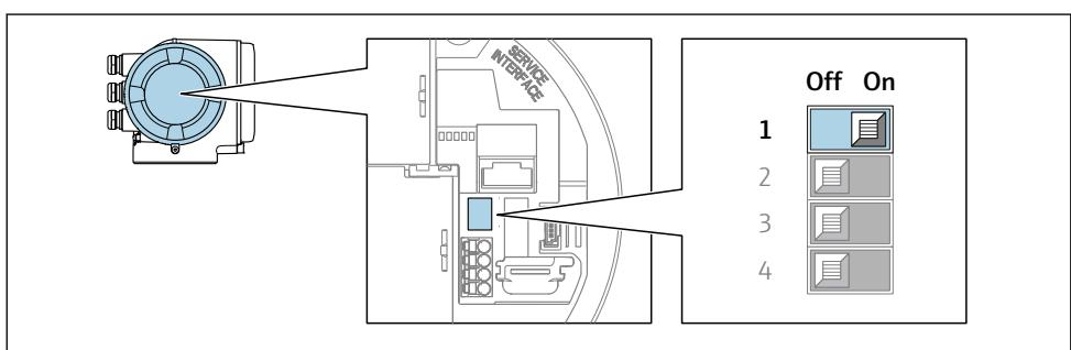
Для активации аппаратной защиты от записи (WP) установите переключатель защиты от записи в главном электронном модуле в положение **Вкл..**
