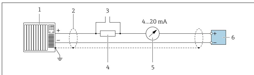
■ 16 Пример подключения для токового выхода 4...20 mA HART (активного)
