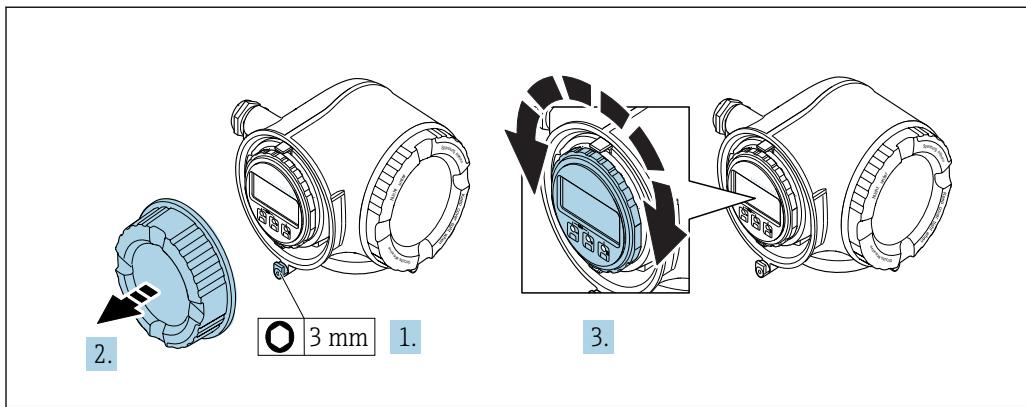
1. Освободите зажим крышки клеммного отсека.
