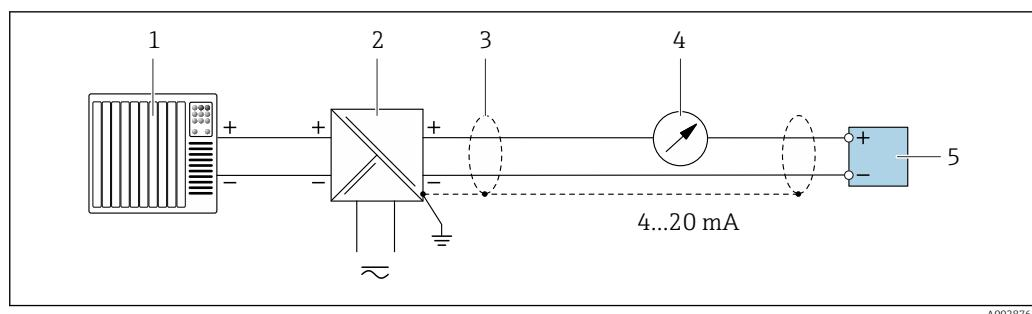
■ 17 Пример подключения для токового выхода 4...20 mA HART (пассивного)
