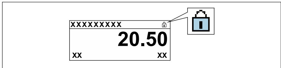
5. Для деактивации аппаратной защиты от записи (WP) установите переключатель защиты от записи в главном электронном модуле в положение **Выкл.** ( заводская установка).
