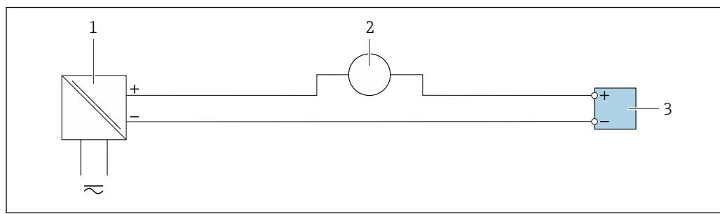
■ 26 Пример подключения для токового входа 4...20 mA
