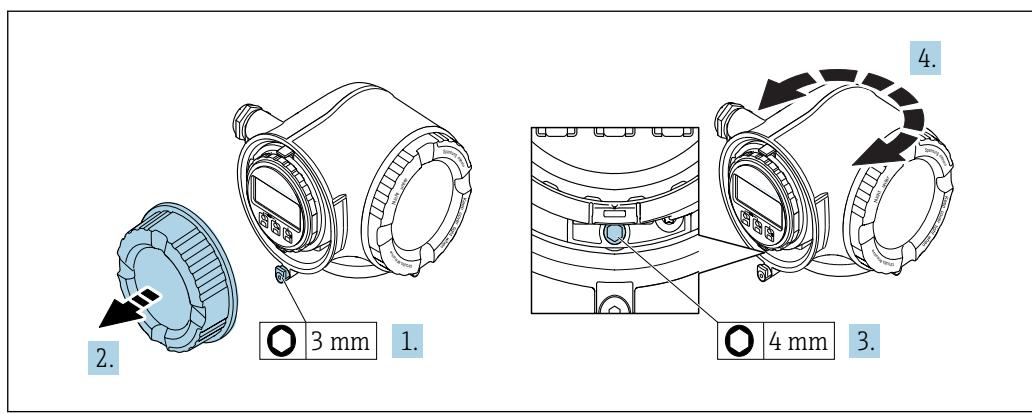
1. Освободите зажим крышки клеммного отсека.
