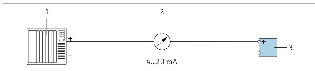
■ 19 Пример подключения для токового выхода 4-20 mA (активного)
