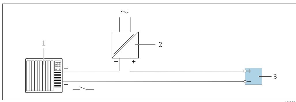
■ 27 Пример подключения для входного сигнала состояния
