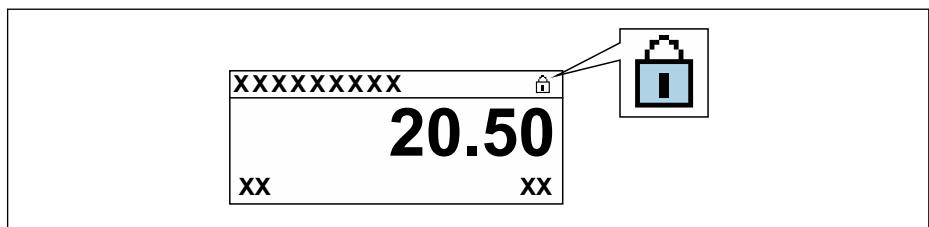
2. Для деактивации аппаратной защиты от записи (WP) установите переключатель защиты от записи в главном электронном модуле в положение **Выкл.** ( заводская установка).
