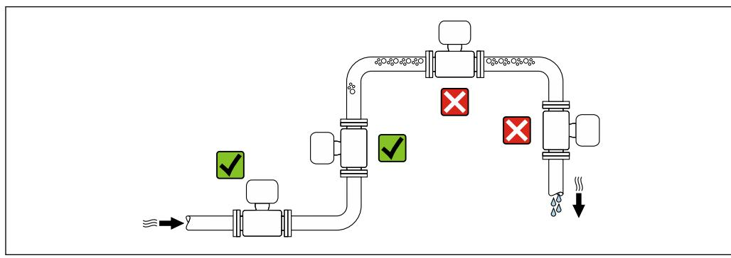
Скапливание пузырьков газа в измерительной трубе может привести к увеличению погрешности измерения. Поэтому не допускается монтаж расходомера в следующих точках трубопровода:
