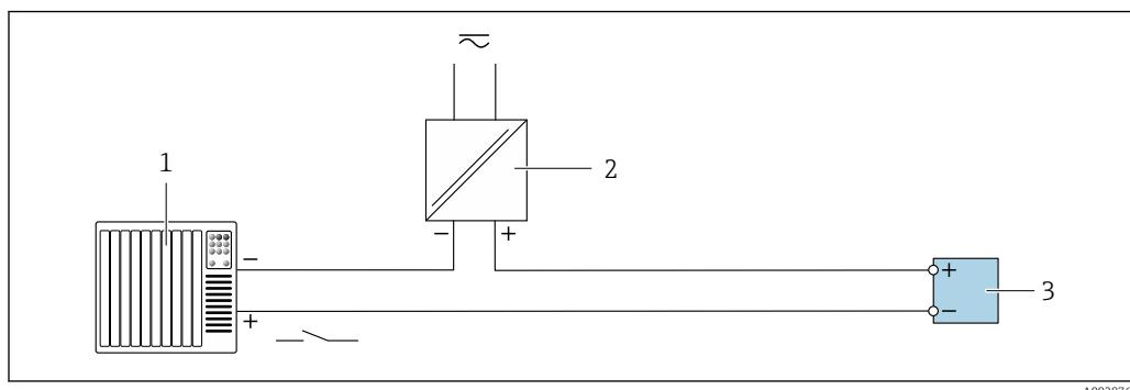
■ 18 Пример подключения для входного сигнала состояния
