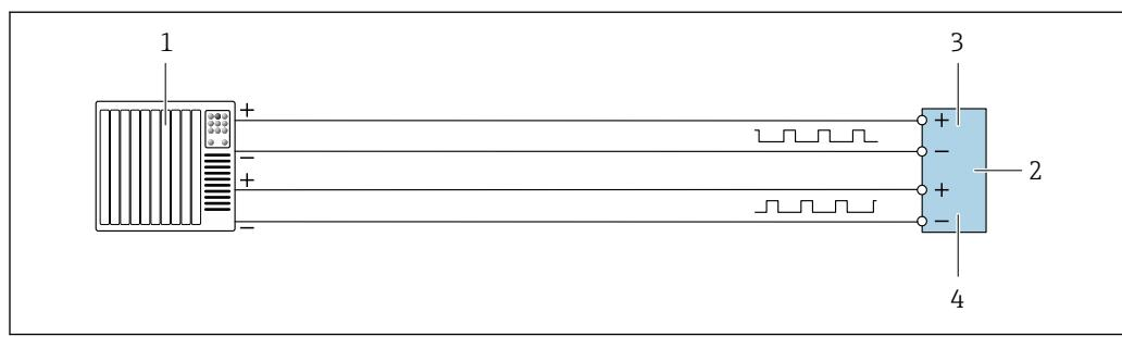
■ 14 Пример подключения двойного импульсного выхода (активного)
