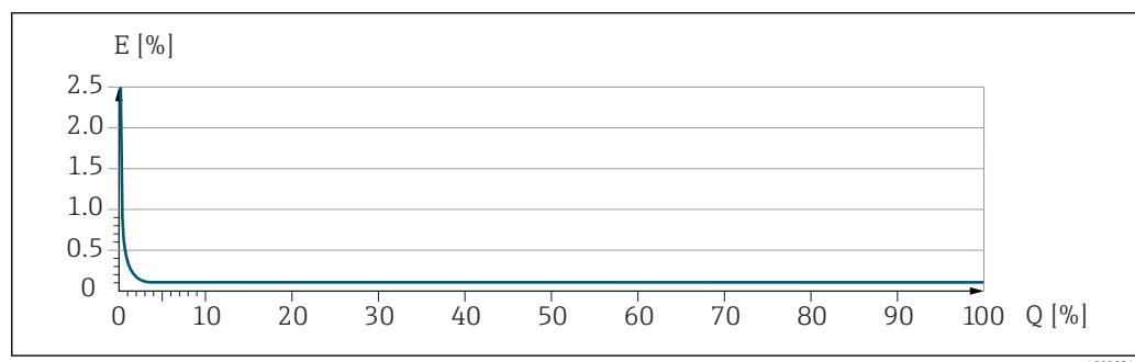
$E$  Погрешность: максимальная погрешность измерения, % ИЗМ (пример)
