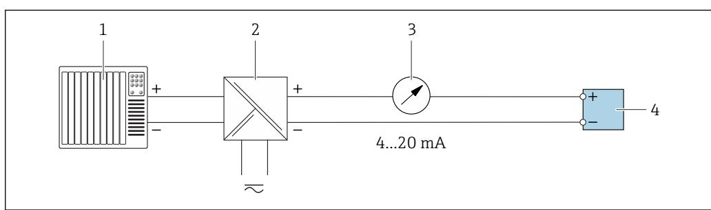
■ 11 Пример подключения для токового выхода 4-20 мА (пассивного)
