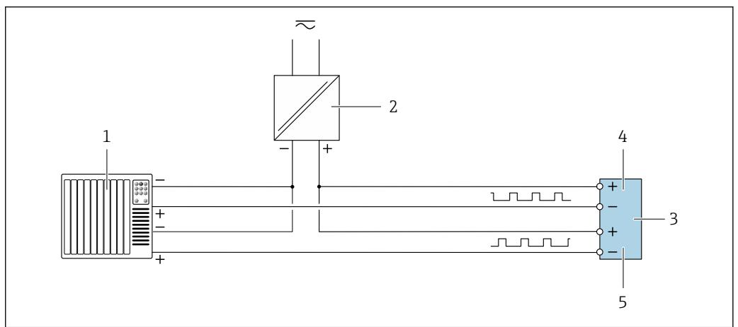
■ 15 Пример подключения двойного импульсного выхода (пассивного)
