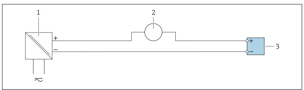
■ 17 Пример подключения для токового входа 4...20 mA
