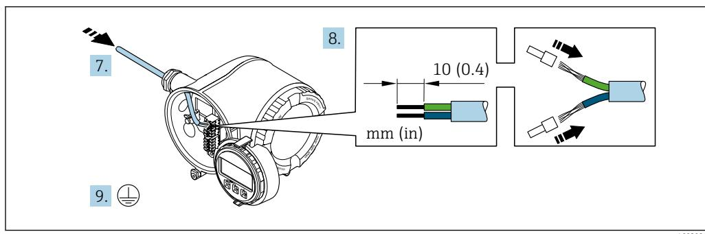
7. Протолкните кабель через кабельный ввод. Чтобы обеспечить непроницаемое уплотнение, не удаляйте уплотнительное кольцо из кабельного ввода.
