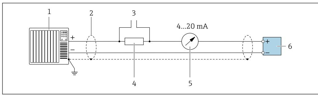
■ 7 Пример подключения для токового выхода 4...20 mA HART (активного)
