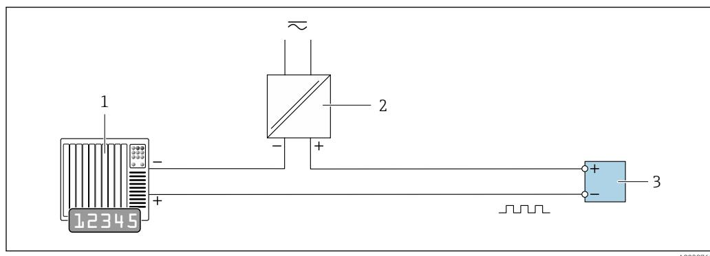
■ 12 Пример подключения для импульсного/частотного выхода (пассивного)
