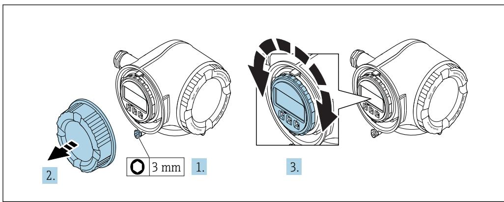
1. Освободите зажим крышки клеммного отсека.
