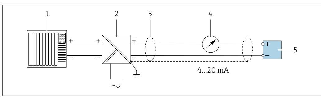
■ 8 Пример подключения для токового выхода 4...20 mA HART (пассивного)
