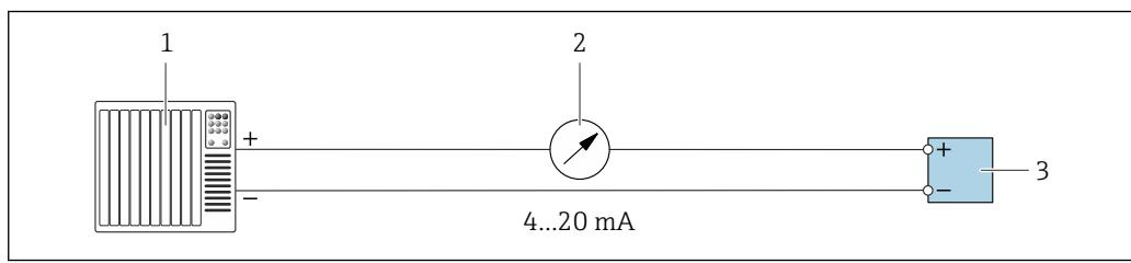
■ 10 Пример подключения для токового выхода 4-20 мА (активного)
