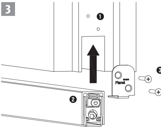
**Montage der Dichtung:** ① vorbohren der Schraubenlöcher; ② Dichtung einlegen; ③ Haltwinkel befestigen
