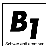
Испытание на огнестойкость DIN 4102
