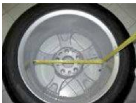
Рисунок 3.3.1 – Пример ручного измерения внешнего диаметра (da2) колеса в типах программ als1/Als2
