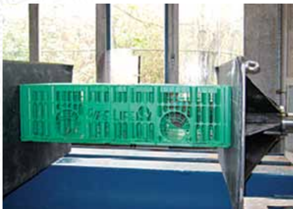
Испытание на устойчивость к нагрузкам
