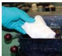
В течение нескольких минут клей расплавится и будет готов к нанесению. Очистка плавильного бака осуществляется стандартным способом с применением очистителя **КЛЕЙБЕРИТ 761.7** в форме гранулята.
