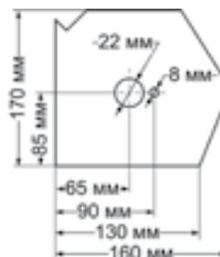
Рис.7. Геометрические размеры теплообменника СВК-А
