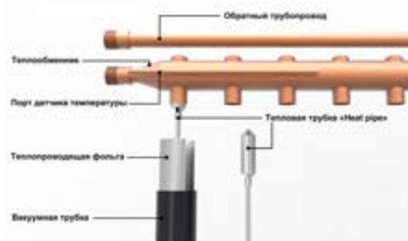
Рис 3. Конструкция теплообменника солнечного вакуумного коллектора
