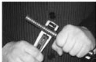
Рис 1 Аккуратно разрезаем трубу
