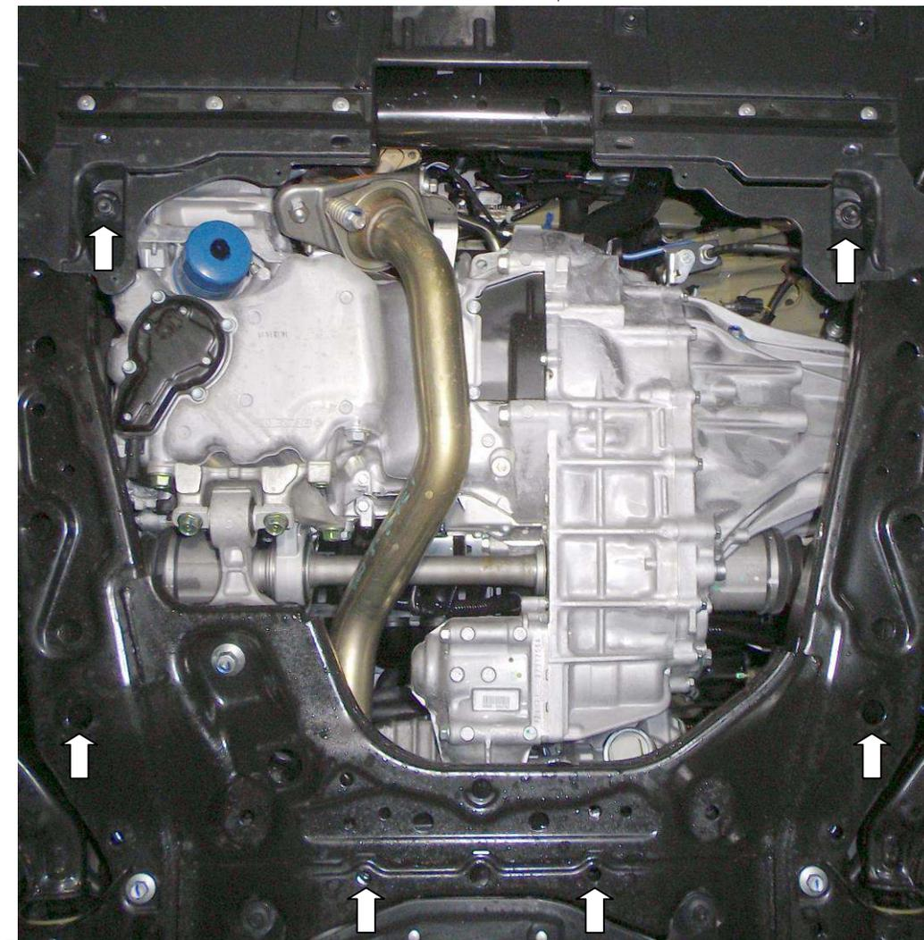
1. Снять 2 передних боковых пистона пластикового пыльника.
