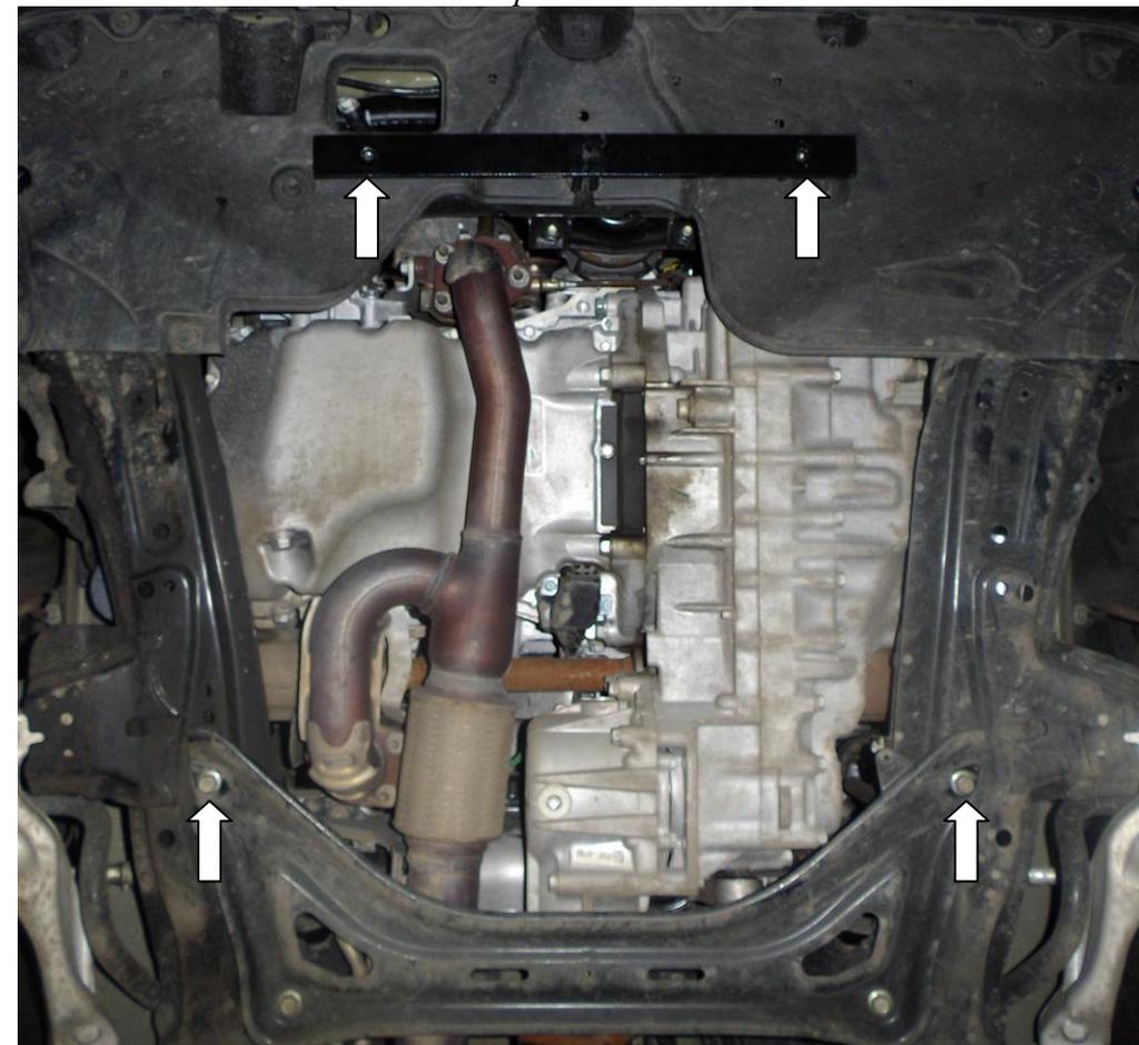
1. Установить балку 2 к крюку по центру подрамника автомобиля болтом 4 и гайкой 5 с шайбами 6,7, рис.1.
