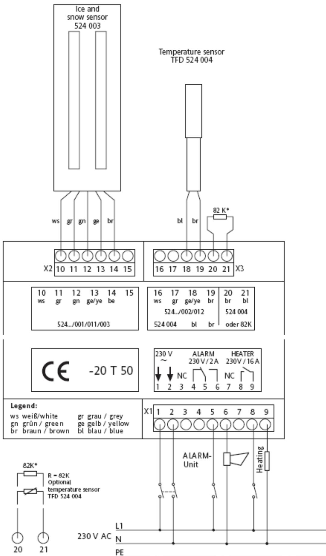
Схема подключения для детектора льда с датчиками ESD 524 001 и TFD 524 002 для обогрева подъездных путей
