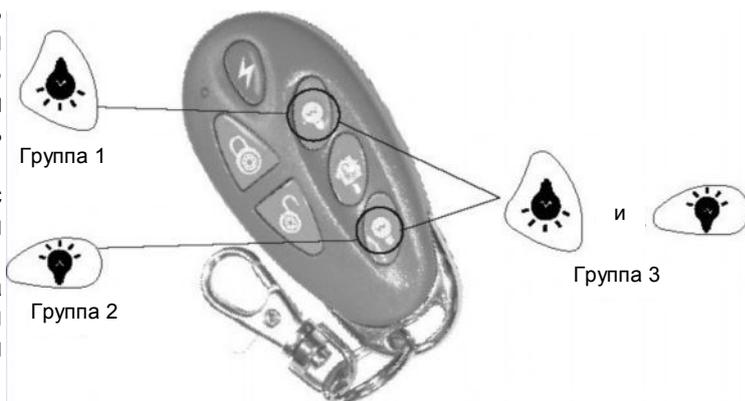
2. Кнопки электронного управления (переключения) можно разделить на 3 независимые группы, каждая группа может управлять одним беспроводным электронным переключателем, как это показано на рисунке. Кнопки каждой группы могут нажиматься одновременно с кнопками для управления сигнализацией. Кнопки каждой группы могут управлять одним беспроводным электронным переключателем.
