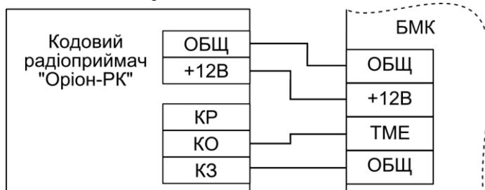
Рисунок 4 - Схема підключення кодового радіоприймача «Оріон-РК»
