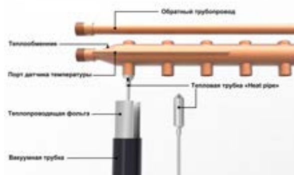
Рис 3. Конструкция теплообменника солнечного вакуумного коллектора
