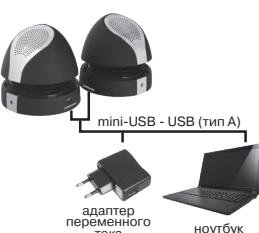
Для зарядки встроенного аккумулятора подключите аппарат при помощи прилагаемого в комплекте кабеля USB (тип A) - USB (тип A) к компьютеру или адаптеру" переменного тока (220-вольт). Во время зарядки будет гореть красный диод. Если аппарат включен и работает от аккумулятора, то цвет диода - зеленый.
