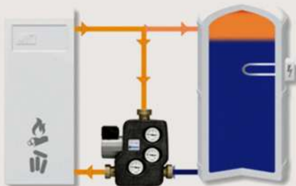
Вентиль обеспечивает функцию контура котла в начале отопления
