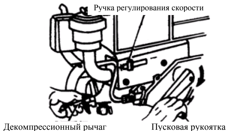
Рис. 11 Запуск двигателя при помощи ручной пусковой рукоятки
