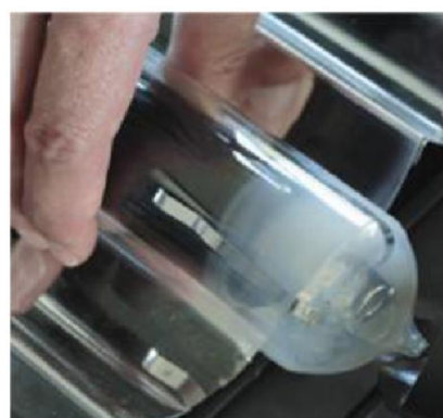
газопоглотитель разрушен, трубка неисправная
