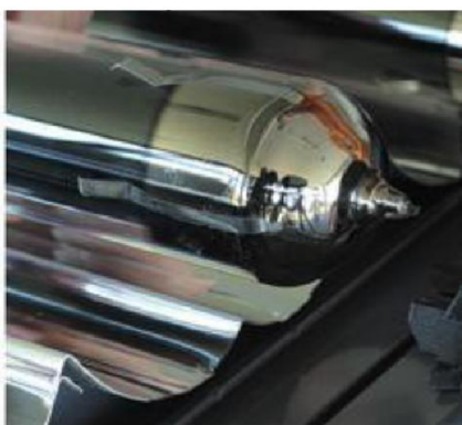
газопоглотитель в порядке, трубка исправная
