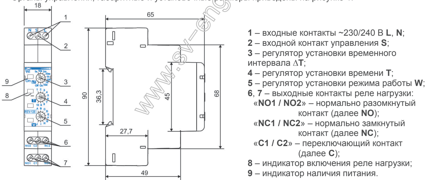
Рисунок 1 – Органы управления, габаритные и установочные размеры REV-120
