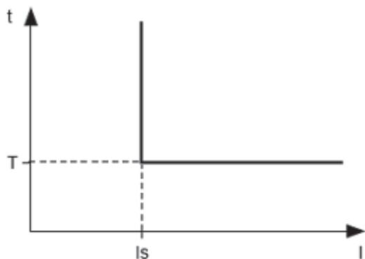
Рисунок 3.1 – Принцип защиты с независимой выдержкой времени
