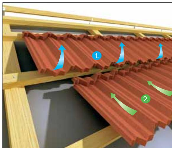
Листы необходимо укладывать в шахматном порядке с боковым смещением, двигаясь сверху вниз с использованием отрезанной части листа черепицы в примыкании к торцевой стене.
