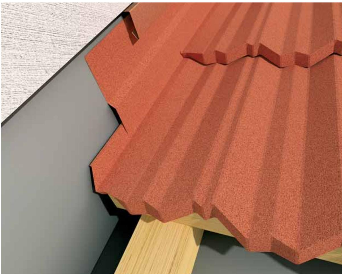
Там, где крыша/стена проходят в горизонтальной плоскости, принципы вентиляции такие же, как и для конька. Важно загнуть края черепицы под примыкание (см. стр. 30; КОНЕК/Резка и сгибание кровельного листа).
