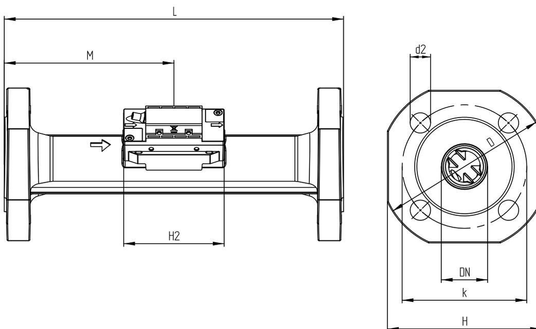
Датчик расхода с фланцевым соединением от ДУ25 до ДУ50
