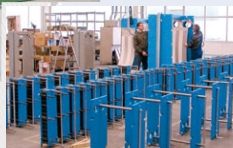
Участок конечной сборки малогабаритных и средних аппаратов
