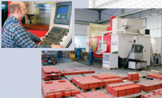
Установка CNC для производства корпусов ПТО
