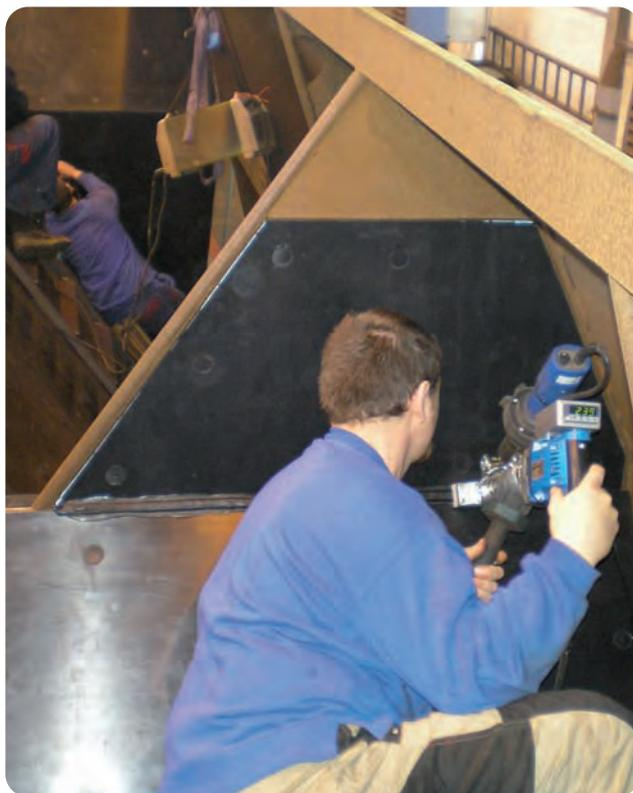
Сварочные работы при облицовке товарного вагона: для предотвращения осадения сыпучего материала в углах облицовка Matrox сваривается в местах угловых стыков.
