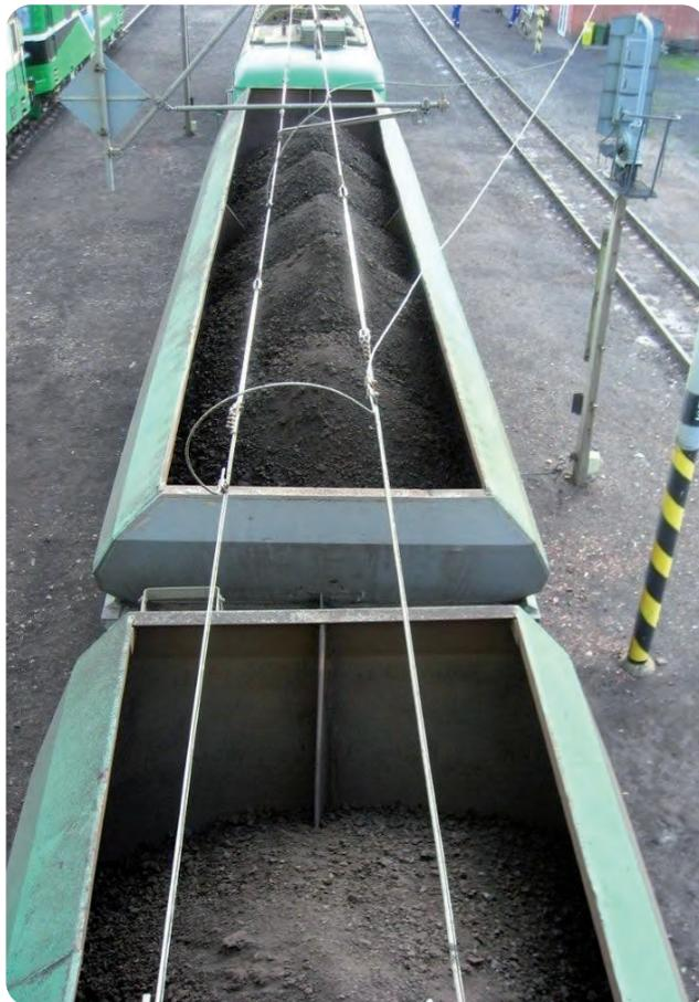
Облицовка вагона плитами Matrox SI 12: непрерывное и полное опорожнение каждого вагона в отдельности обеспечивает быструю разгрузку всего товарного поезда.
