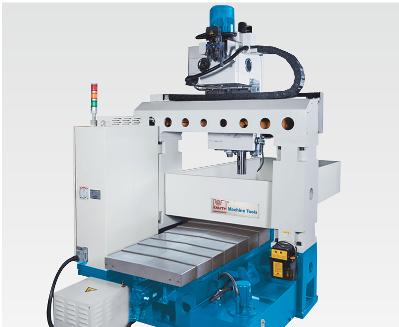
Массивный фиксированный портал для максимальной устойчивости
