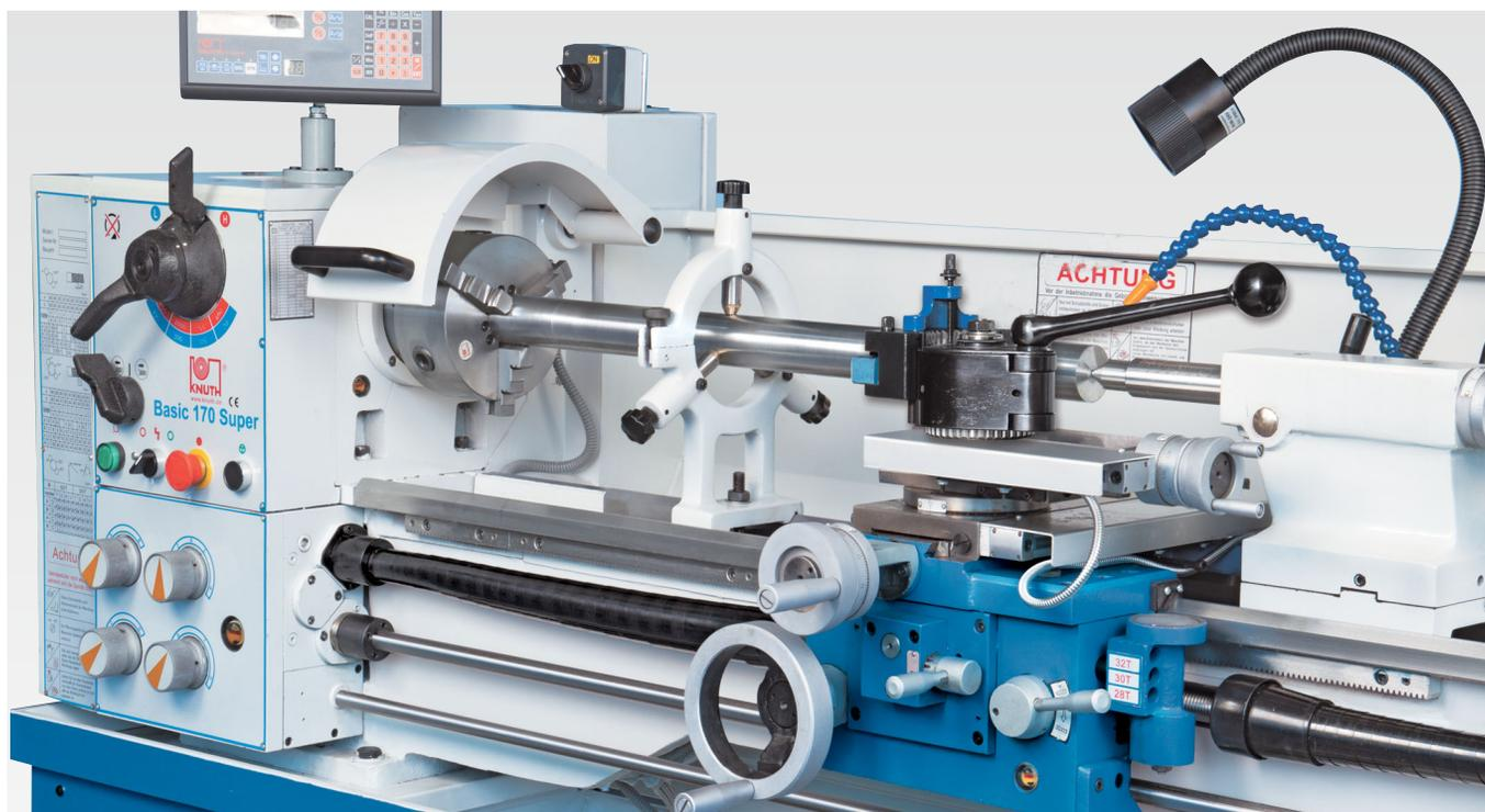
Фиксированный люнет (серийный) для обработки длинных заготовок
