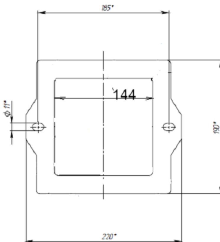
Рис. 4 – Чертеж монтажных отверстий горелки
