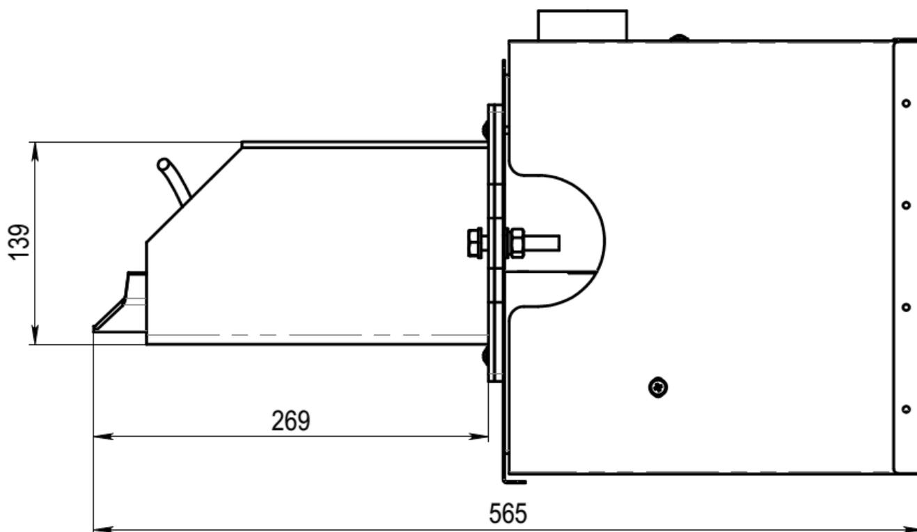
Рис. 3 – Габаритные размеры горелки
