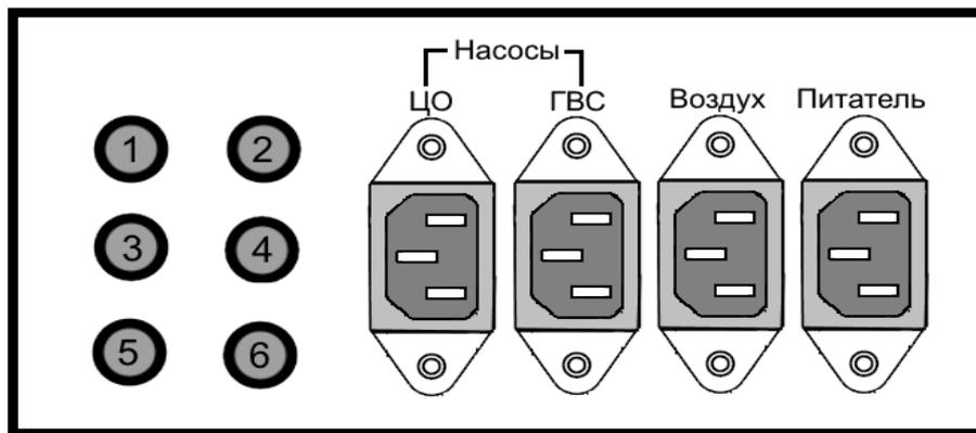
Рис. 8 – Задняя панель блока управления AIR BIO PID.
