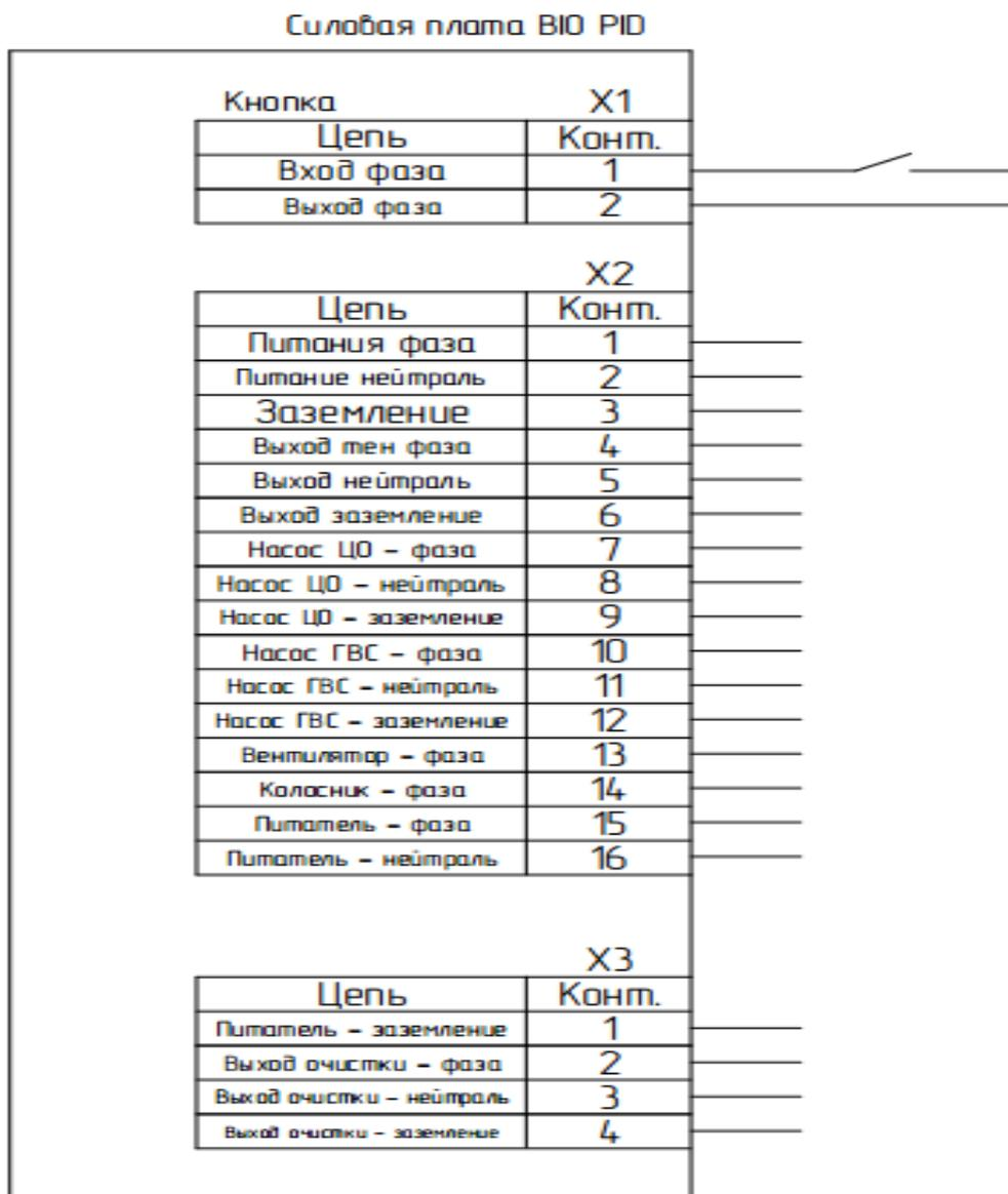
Рис. 9 – Подключение цепей на силовой плате БУ
