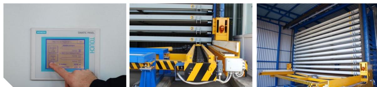
Механизированный склад предназначен для складирования листового проката в специальных кассетах с помещением в ячейки склада. Максимально допустимые размеры листов для складирования 6100 x 2050 мм. Листы меньшей размерности укладываются на кассеты в два ряда
