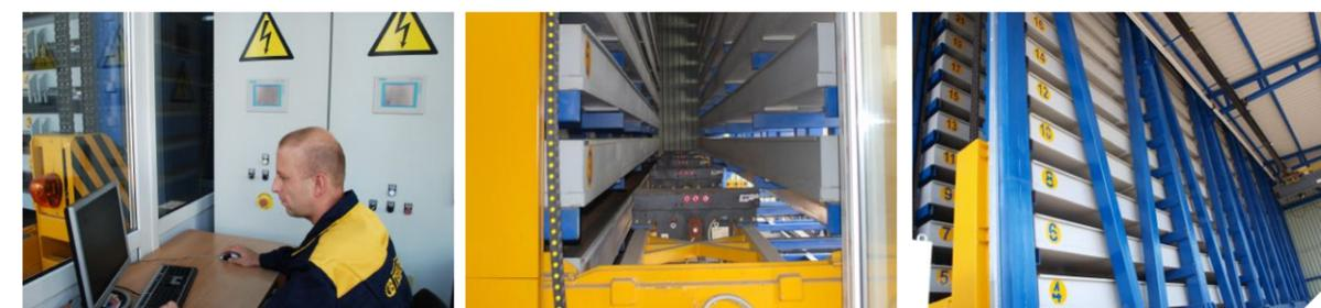
Механизированный склад предназначен для складирования профильного проката в специальных лотках с помещением в ячейки склада. Максимально допустимая длина проката для складирования 12400 мм. Максимальная загрузки одного лотка составляет 3000 кг. Максимальный вес ограничивается датчиками веса на подающем конвейере.
