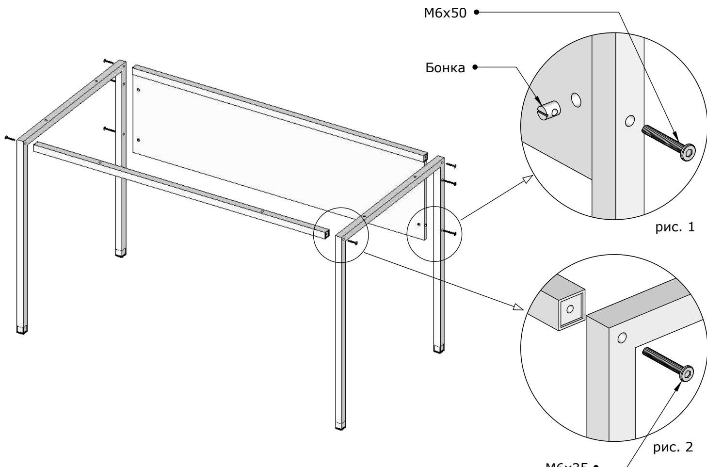
В глухие отверстия на плоскости передней панели вставляем бонку.
