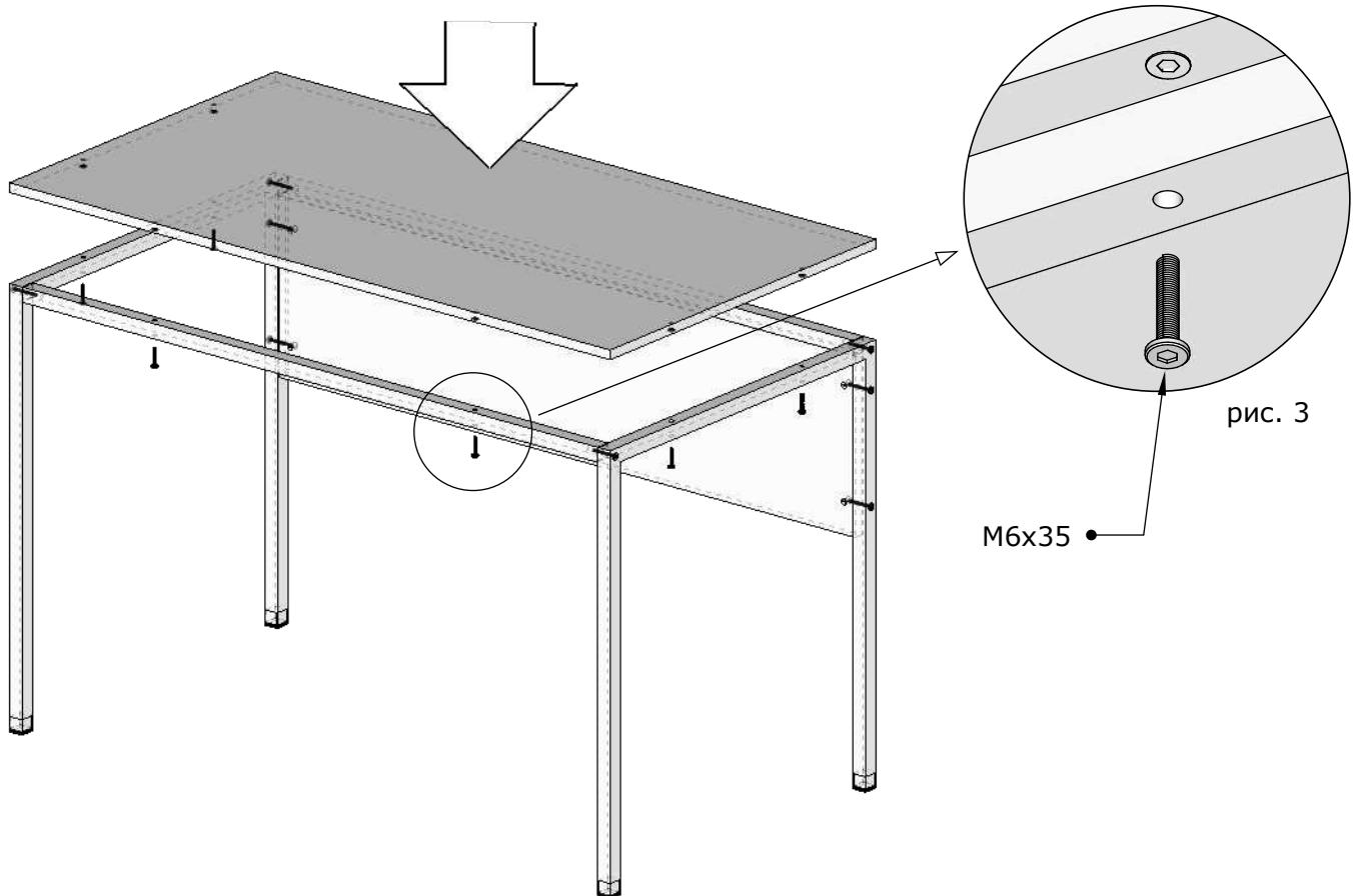
Крепим столешницу винтами М6х35. **Винты до конца не затягиваем!**
