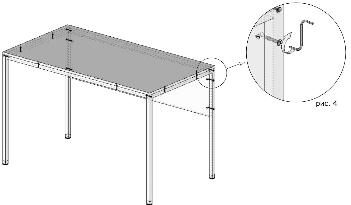
Крепко затягиваем весь крепеж так, чтобы все узлы конструкции сошлись верно.
