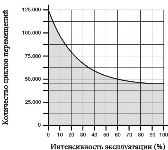
*Пример расчета срока службы редукторного двигателя Wingo WG5024 (см. данные Таблицы 2 и Графика А):*
