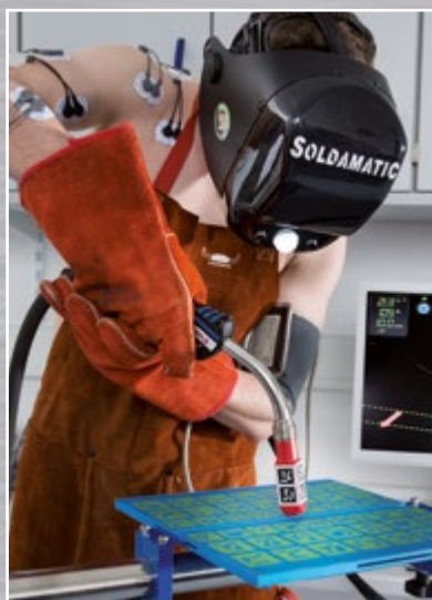
MB EVO PRO 36 в сварочной позиции PA (горизонтальная сварка стыковых и угловых швов).
