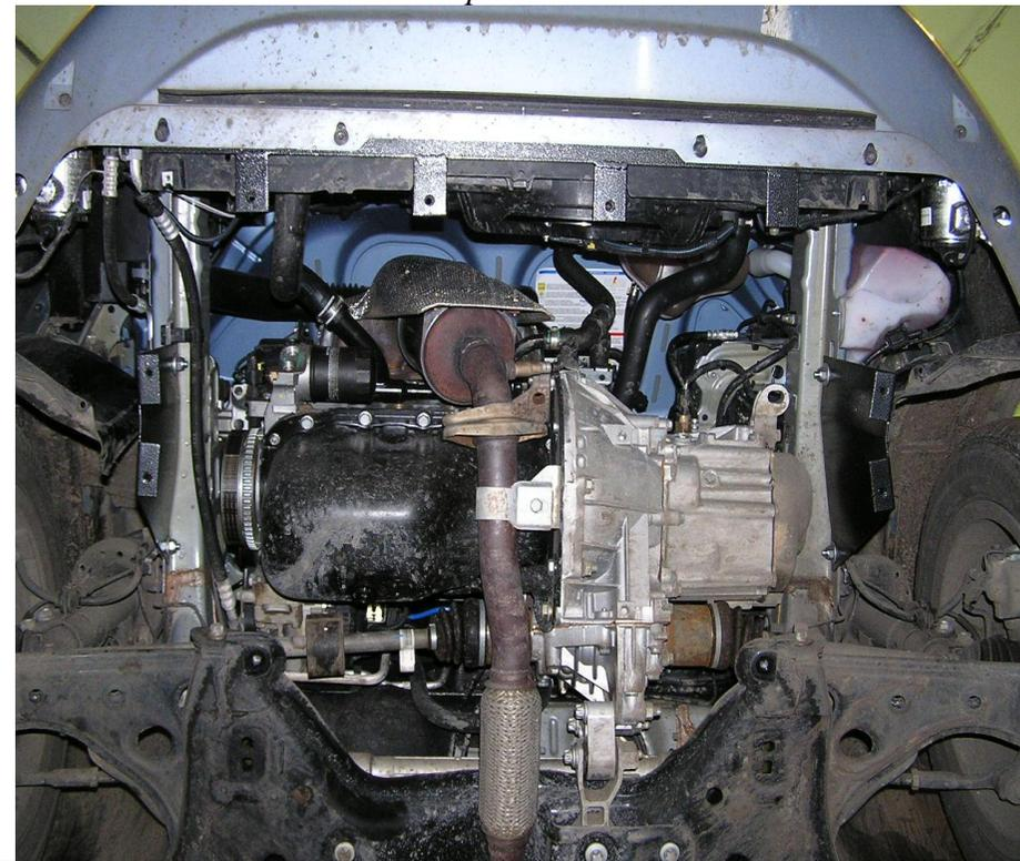
1. Снять боковой пыльник с правой (по ходу автомобиля) стороны и очистить места крепления от оригинального крепежа.
