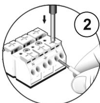
Натиснути викруткою на кнопку колодки і вставити дрот в контактний отвір до упору. Між колодкою та ізоляцією дроту не повинно залишатися оголеного дроту.
