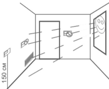
1. Зафіксуйте базову частину термостата в обраному місці за допомогою гвинтів.
