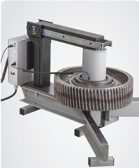
Нагреватели серии T1H L MB предназначены для нагрева отличных от подшипников деталей весом до 600 кг (1323 фунта), в зависимости от модели.
