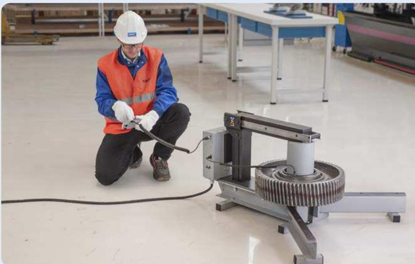
В целях безопасности индукционный нагреватель серии T1H L MB оснащается панелью дистанционного управления.
