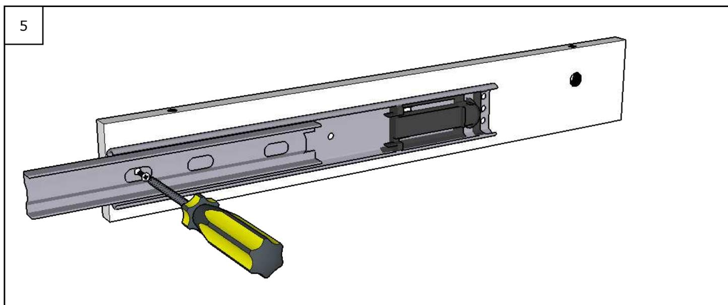
К боковым стола (детали 1 и 2) прикручиваем внешние части направляющих саморезами М3х16
