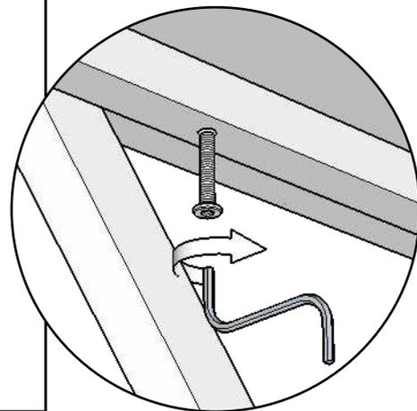
Прикручиваем каркас к дну с помощью винтов.
