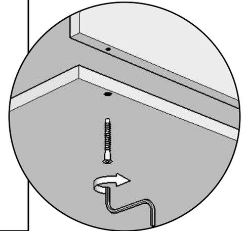
Деталь 4 (Дно) прикручиваем с помощью конфирматов к деталям 1, 2, 5, 6 и 7.
