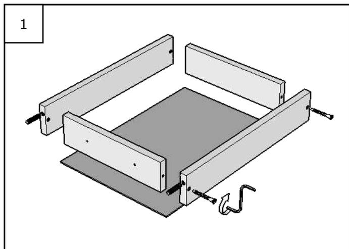
Детали 9 и 10 (по 2шт.) и соединяем их между собой с помощью конфирматов.
