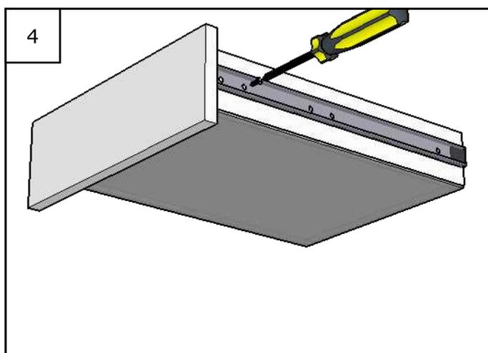
Прикручиваем внутреннюю часть направляющих к боковым деталям ящика саморезами М3х20
