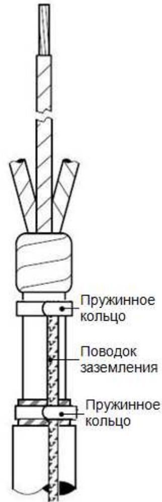
4.1. Расположите поверх свинцовой оболочки кабеля поводок заземления и зафиксируйте его посредством двух пружинных колец постоянного давления. Одно кольцо следует расположить поверх свинцовой оболочки, второе – поверх стальной брони, как это указано на рис. 4.
