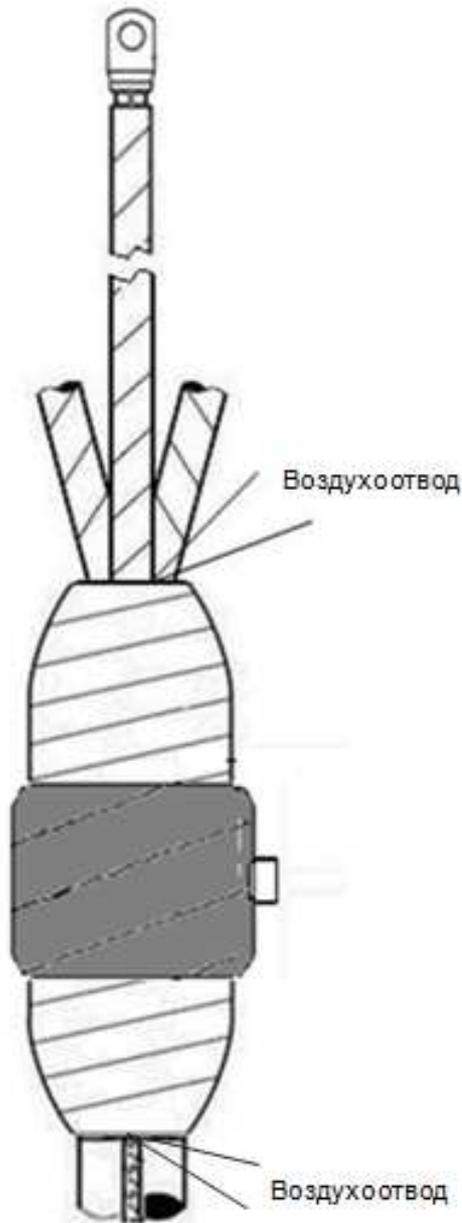
11.1 Осуществите сверху и внизу объемного срезка проколы небольшого отверстия для воздухоотвода.
