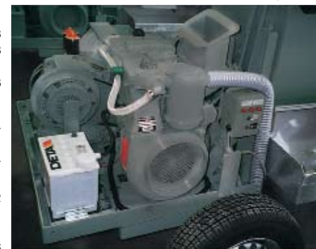
Очень надежный и не требующий обслуживания 2-цилиндровый дизельный двигатель мощностью 12,5 кВт.
