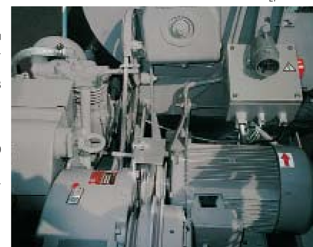
Мощный электродвигатель 400 В достигает 7,5 кВт. В S-версии даже 11 кВт.
