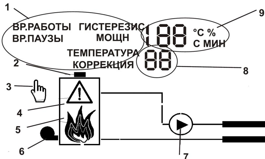
1. Название устанавливаемого параметра – высвечивается во время подсмотра и изменения установки
